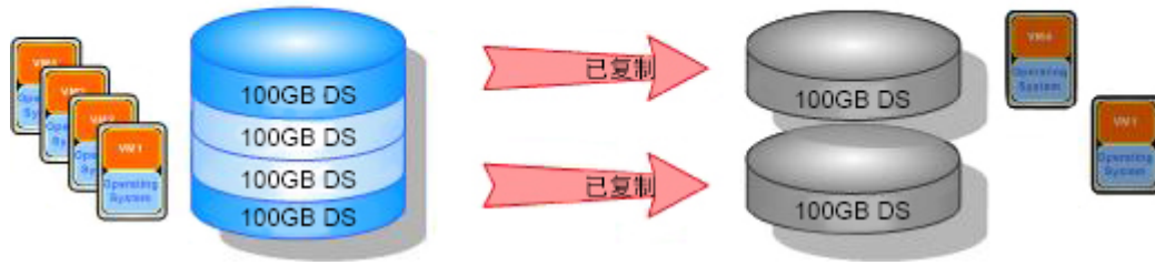
图 3: 多虚拟磁盘复制
